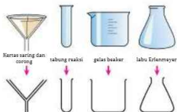
Gambar 1.6 Diagram alat digambarkan dalam bentuk 2-dimensi.
