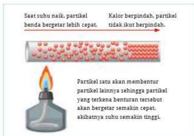
Gambar 3.8 Perpindahan kalor secara konduksi pada logam.
