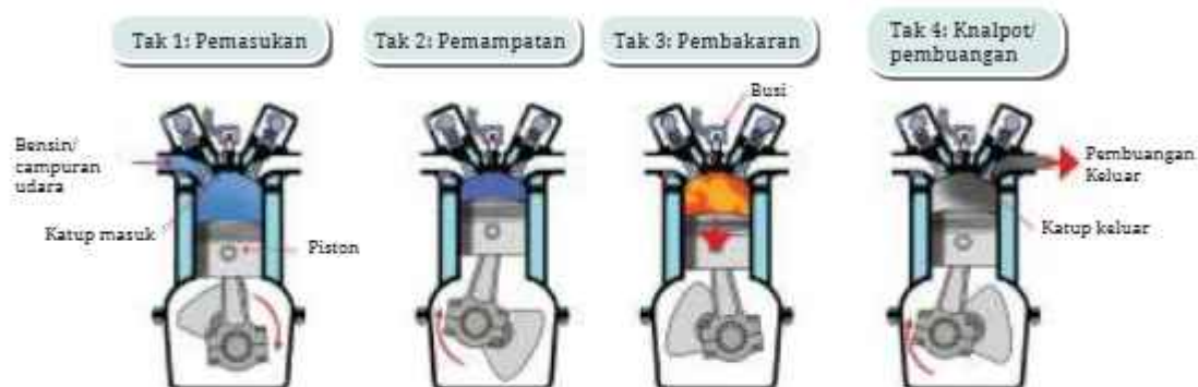
Gambar 3.22 Proses pembakaran pada mesin mobil/motor
