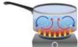
Gambar 3.10 Konveksi saat memasak air.
