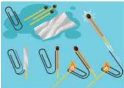
Gambar 4.15 Roket korek api dengan bahan alumunium foil dan klip kertas.
