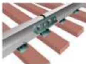
Gambar 3.14 Sambungan rel kereta api dibuat berongga.
